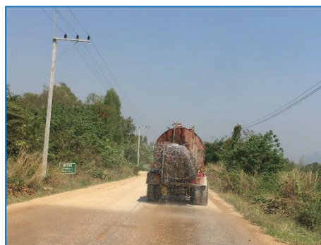
รูปที่ 2-23: การฉีดพรมน้ำบริเวณเส้นทางลำเลียงแร่
